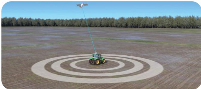
内蔵しているIMUより地形補正可能
