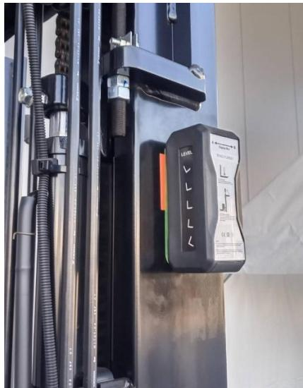
4. 「Leveling Box」と記載されている面を上側にしてフォークの上に置きます。
