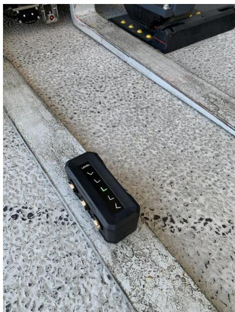
5. フォークリフトのチルトコントロールを使用して、「DisplayBox」に安定した緑色のライトが現れるまでフォークをゆっくりと傾けます。
