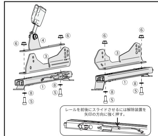
締め付けトルク M8 24±2 Nm
