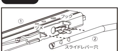
※スライドレバー②には、長さが調節できるよう3つ穴がありますが、手順7のシート本体の取り付けポジションによってはレバーとシート本体が干渉する場合があります。必ず使用前に干渉なく操作できることを確認して取り付け穴を決定してください。
