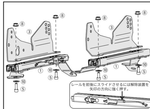
締め付けトルク M8 24±2 Nm
