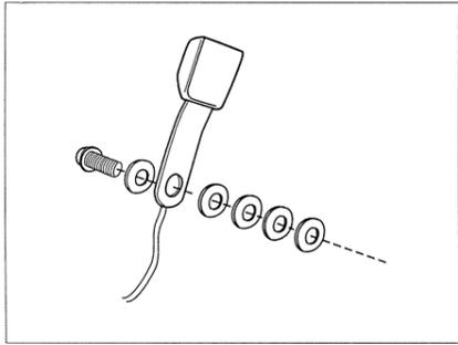
純正シートに装備されているシートベルトバックルを取り外します。
