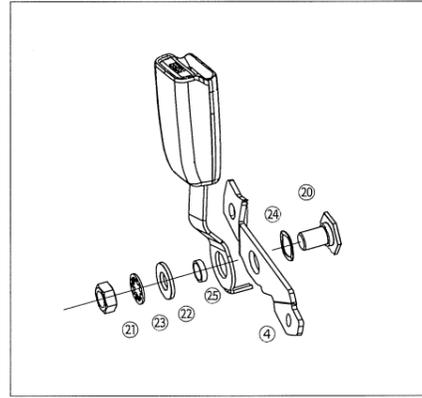
取り外したシートベルトバックルを、付属の取付部品を使用して専用ベルトアンカーブラケット④に取り付けます。
