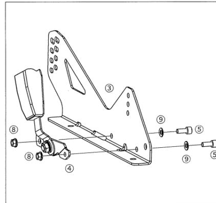
上記専用アンカーブラケット④を、付属の取付部品を使用して専用サイドアダプター③に取り付けます。
