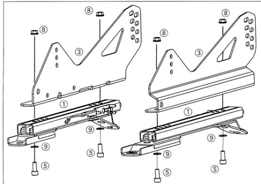
ベースフレーム本体①のロック解除装置を操作し、レールを前後にスライドさせてベースフレーム本体①と付属の専用サイドアダプター③を下記締め付けトルクにて取り付けます。
