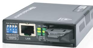
PMC-100PD は、Power over Ethernet (PoE) 対応の 10/100Base-TX から 100Base-FX への非管理型 PD (受電機器) 用ファイバーコンバーターです。最も一般的なファイバーケーブル用コネクタである SCが利用可能です。マルチモードおよびシングルモードのコンバーターモデルに加えて、BiDi (双方向伝送対応) モデルも用意しており、1本の光ファイバーで双方向通信が可能です。PoE機能により、PMC-100PD は PoE 対応イーサネットスイッチから LAN ケーブル経由で電力供給を受け、外部電源アダプターなしで動作可能 です。オートネゴシエーション機能が選択されている場合、本製品は IEEE802.3u 規格に準拠し、ハーフデュプレックス/フルデュプレックス信号の両方に自動対応します。
