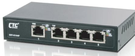
CTC Unionの「EXT-G104P」は、AC/DC電源不要で動作する産業用5ポートPoEエクステンダーです。1ポートのPoE++/PD準拠RJ45ポートは、IEEE802.3bt規格に準拠したPoEインジェクターやPoEエクステンダーから最大90Wの電力供給を受け、その電力を4つのPoE+/PSE対応RJ45ポートを通じて、IPカメラ、WiFiアクセスポイント、VoIP電話機などのPD機器に供給します。100メートル以上のPoE伝送距離を実現し、PoE展開の柔軟性と経済性を大幅に向上させます。設定不要のプラグアンドプレイ設計により、導入や保守も簡単です。
