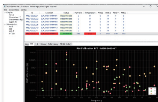
図3: MSU振動FFT
